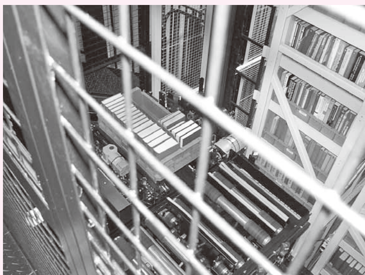
▲自動書庫では、パソコンで取り出し指示を出した図書をコンテナで運ぶ
